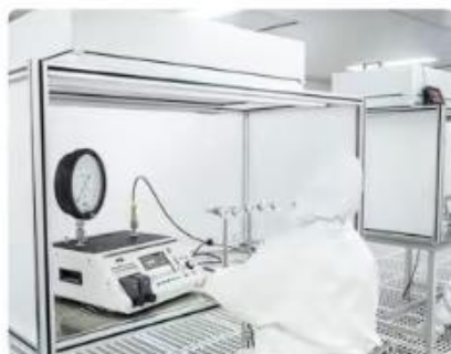
高纯压力表示值精确度检测
