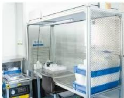
洁净罩内真空包装 (充氮气封装)
